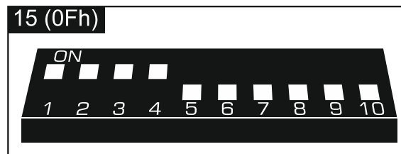
Rys. 14. Sposób ustawienia adresu na przykładzie ekspandera INT-O.
